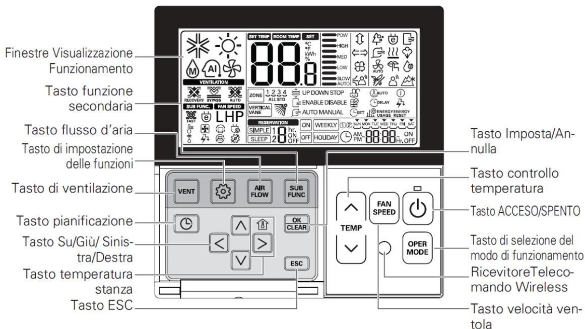
**Finestre Visualizzazione Funzionamento:** Mostra lo stato di funzionamento e le impostazioni
